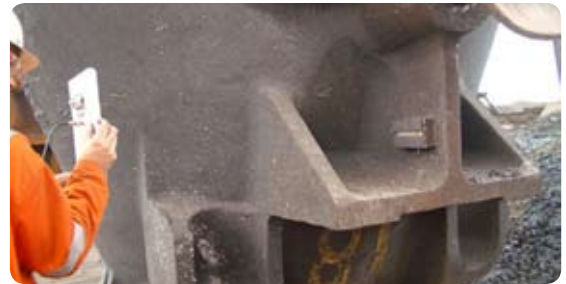
Der Piezokristall hält extremen Temperaturen stand und kann Schlackenkübel per Funk überwachen.
