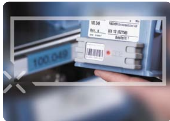
Herzstück des Systems: Die aktiven RFID-Transponder geben infolge der veränderten Lage den Bestellimpuls.
