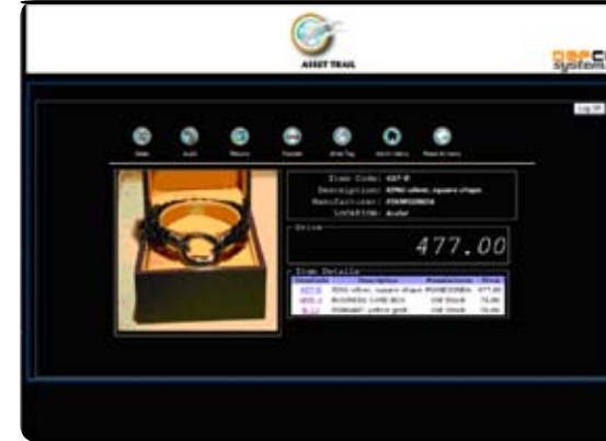
Die einzelnen Schmuckstücke lassen sich über die auf den Transpondern gespeicherten Daten automatisch identifizieren.
