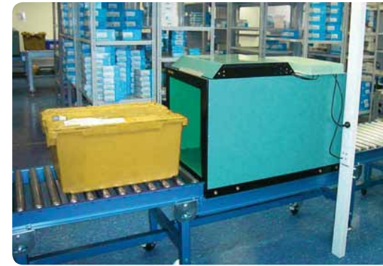
Pulkerfassung in der Pharmadistribution: Mit einem Tunnel-Lesegerät basierend auf dem PJM-Verfahren werden 200 Arzneimittelpackungen trotz Blisterverpackungen mit Aluminiumfolie und undefinierter Anordnung zu 100 Prozent erfasst.
