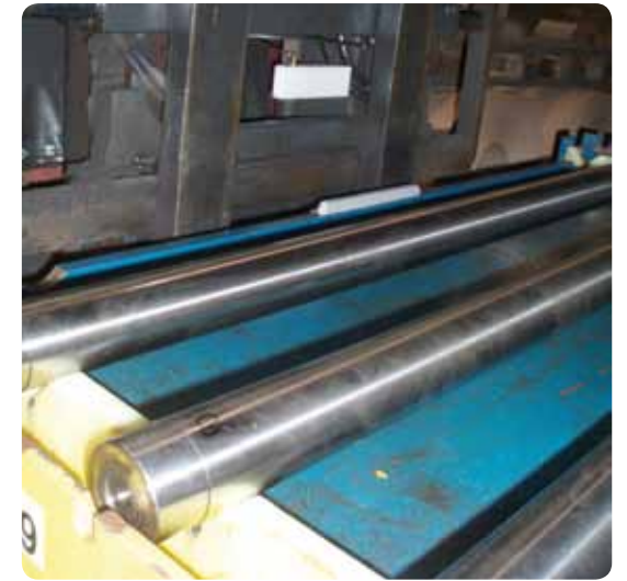
Kassette mit Walzen auf einem Stapler mit RFID-Antenne
