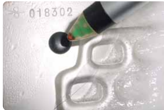
Der Temperatursensor-Transponder misst die Innentemperatur eines Kühlschranks.
