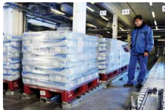
Die UHF-Transponder sind in den Palettenfuß eingebracht. Mit einem Handheld werden alle Paletten lückenlos erfasst.
