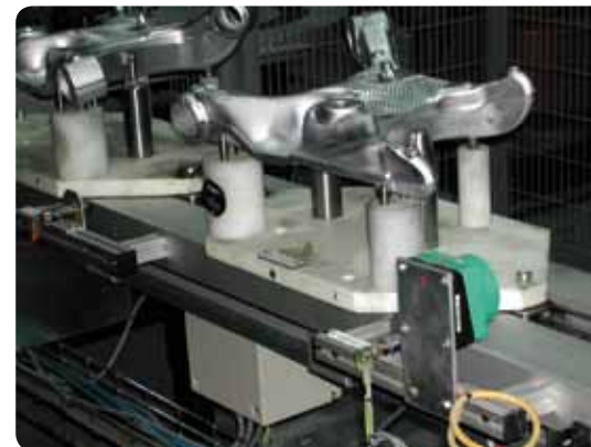
Ein RFID-Schreib-/Lesekopf steuert die Produktion von Alu-Teilen für die Automobilproduktion.
