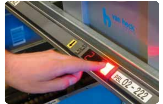
Bearbeitung ohne lange Wege mittels Pick-by-Light™-Systemen
