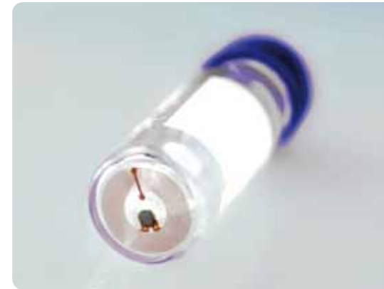
RFID-Transponder im Ampullenboden
