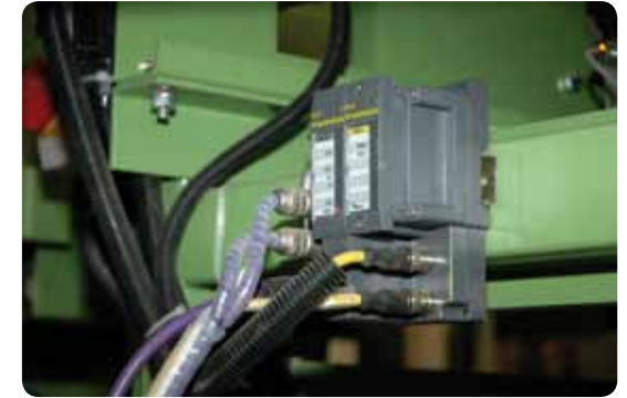
Das System wird auf einer Hutschiene direkt im Feld montiert.
